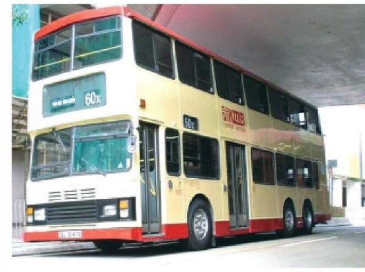
• GL2418 (S3BL364) 前身是ED2914同樣因一次意外焚毀車身換上與熱狗富豪 (S3V1-S3V30) 一樣的全新亞歷山大車身，骨子裡卻是一輛「吉偈蘭」，所以得了「假熱豪」這個稱號。
